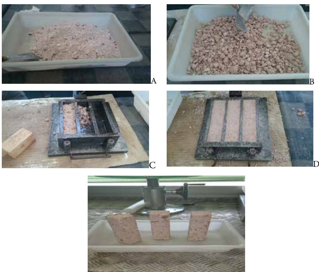
Figura. 4. A) Mezcla de los cascotes, la arena y la cal. B) Adición de polvo de ladrillo y el agua y seguimos mezclando. C) Relleno de los moldes por capas y compactación. D) Enrasamos y dejamos fraguar. E) Aspecto final de las probetas de hormigón Opus Caementicium realizadas en laboratorio.
