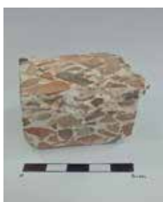
Figura 3. Muestra de "Opus Caementicium" recogida en la ciudad Romana de Valeria.
